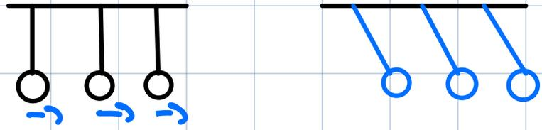
$$\underline{\varphi}_{0,2} = \begin{pmatrix} -1 \\ 0 \\ 1 \end{pmatrix} \quad \begin{array}{l} \text{Pendel 1,3 schwingen gegenphasig,} \\ \text{Pendel 2 bleibt in Ruhe.} \end{array}$$
