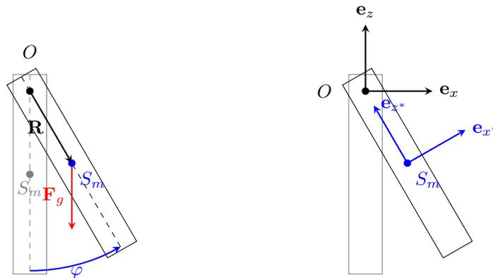
Abbildung 1: Skizze eines physikalischen Pendels, welches um seinen Aufhängepunkt  $O$  oszilliert. Die Gravitation setzt am Schwerpunkt  $S_m$  an und wirke in die negative  $z$ -Richtung des raumfesten Koordinatensystems (**links**). Ebenso sind das raumfeste und körperfeste Koordinatensystem eingezeichnet (**rechts**). Dabei zeige die  $y$ -Achse in beiden Fällen in die Zeichenebene hinein. Es gilt stets  $\mathbf{e}_y \parallel \mathbf{e}_{y^*}$ .
