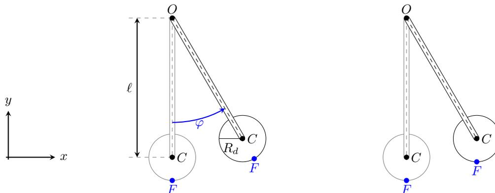
Abbildung 3: Skizze des zusammengesetzten physikalischen Pendels. Man beachte die Lage des Fixpunkts  $F$  für die fest angebrachte Scheibe (**links**) und die frei drehende Scheibe (**rechts**). Die Systeme schwingen um die  $z$ -Achse, welche hier aus die Zeichenebene herausragt und stets parallel zur körperfesten  $z^*$ -Achse liege.
