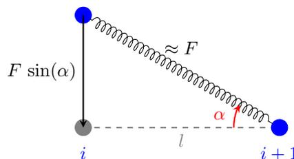
Abbildung 2: Skizze für die vertikale Auslenkung des Kettenschwingers.
