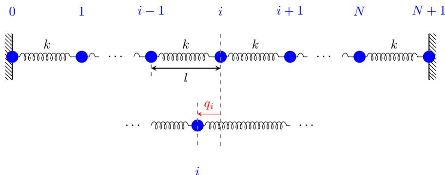
Abbildung 1: Skizze des Kettenschwingers aus  $N$  schwingenden Massen, die mit ihren Nachbarn jeweils mit Federn der Federkonstante  $k$  verbunden sind. Wir bezeichnen die Auslenkung aus der Gleichgewichtslage der  $i$ -ten Masse als  $q_i(t)$ . Die Tatsache, dass die Kette fest eingespannte Enden besitzt, drücken wir durch zwei zusätzliche, unbewegliche Massen aus:  $q_0(t) = q_{N+1}(t) = 0$ .
