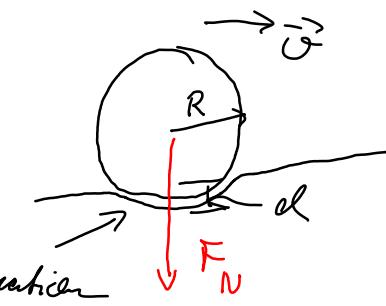
technische  $\mu_R$  0,0005 - 0,001 - Kugellager, Eisenbahnen und
