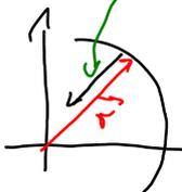
Wenn  $\omega \neq \text{const.} \hat{=} \text{variable Drehrate} \Rightarrow$  auch Eulerkraft.
