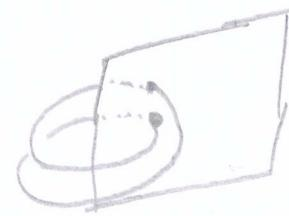
Poincaré-Abbildung:  $\underline{x} \rightarrow P(\underline{x}, u)$  mit  $P(\underline{x}, u)$  als 1. Wiederkehrspunkt auf Fläche  $S$  (Durchstoppunkt)
