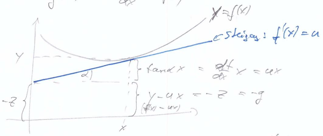
Also: statt  $y=f(x)$ : Trajek  $x \rightarrow u = \frac{df}{dx}$  und (negativer) Achsenabschnitt der Tangente ( $-z$ )
