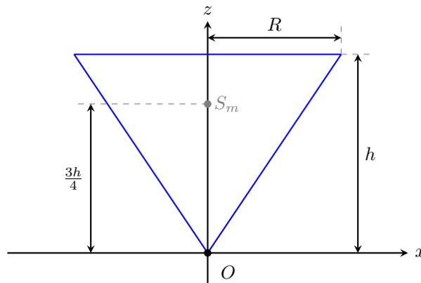
Abbildung 1: Querschnitt in der  $(x, z)$ -Ebene durch den Kegel. Die Spitze des Kegels ruhe im Ursprung  $O$  des Koordinatensystems und die Symmetrieachse verlaufe entlang der  $z$ -Achse. Der Schwerpunkt  $S_m$  liegt in diesem Fall auch auf dieser Achse und hat eine Entfernung von  $3h/4$  zum Ursprung.
